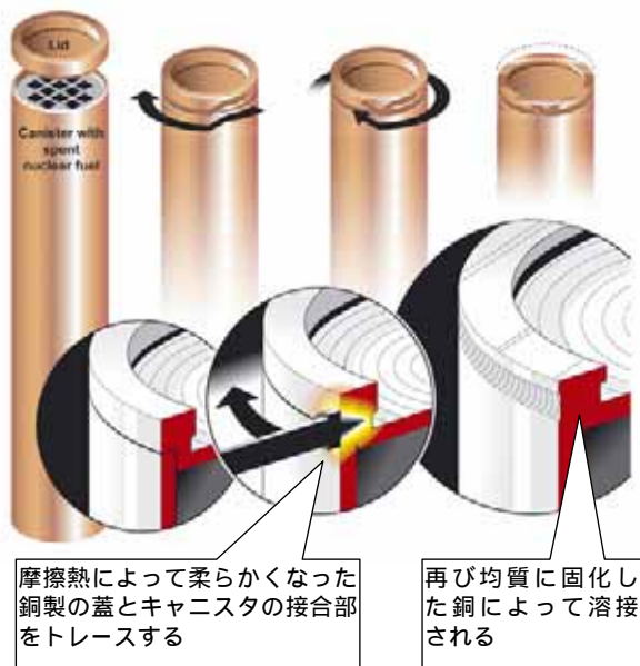
摩擦攪拌溶接の仕組み
