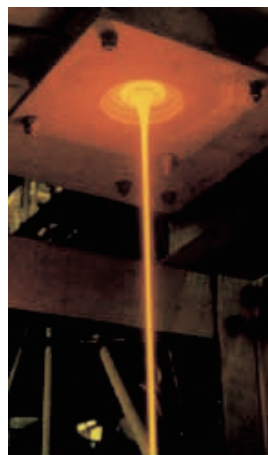
溶融したガラスの注入装置と ガラス固化体用キャニスタ（CSD-V） （ANDRAウェブサイトより引用）
