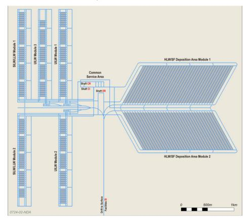
図 2-5 低強度堆積岩 GDF のレイアウトの理想化された平面図の一例
