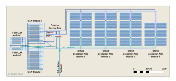
図 2-4 高強度岩における GDF レイアウトの理想化された平面図の一例
