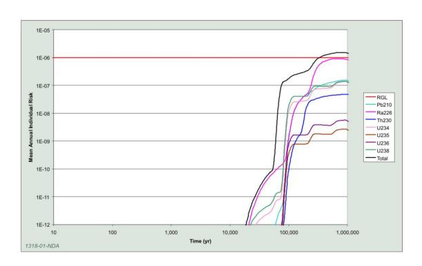
図 2-16 DNLEUにおける鍵となる放射性核種を対象としたレファレンスケースの時の経過に伴う平均放射線リスクの推移
