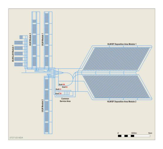
図 2-6 蒸発岩を母岩とする GDF レイアウトの理想化された平面図の一例
