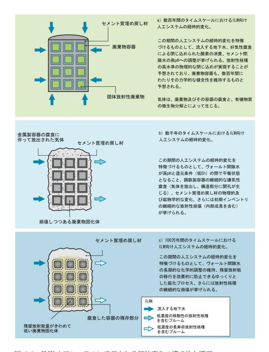
図 2-9 ILW 人工システムに予想される経時変化の模式的な概要
