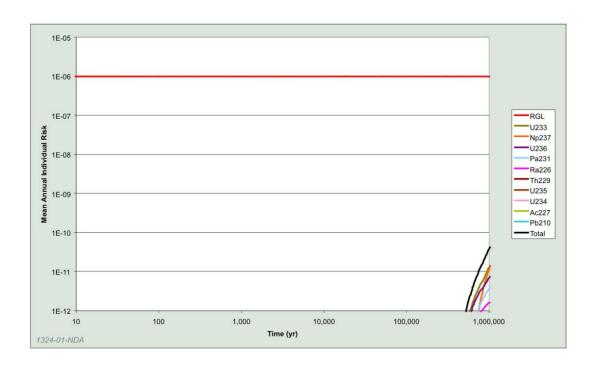
図 2-22 Pu を対象とした、鍵となる放射性核種に関するレファレンスケースの時の経過 に伴う平均放射線リスクの推移
