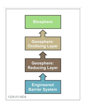
図 2-8 GoldSim トータルシステム・モデルの模式図
