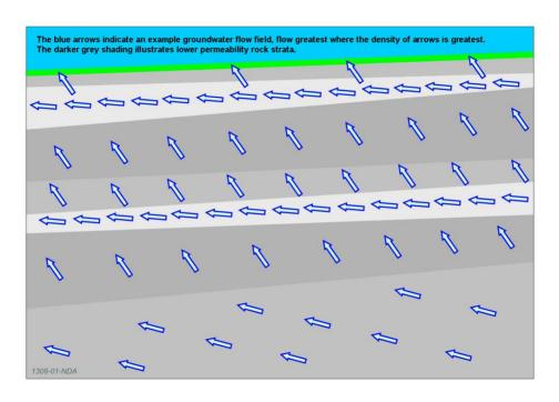
図 2-11 地下水流動場の例の模式図
