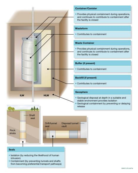
図 2-2 多重バリアシステムの概略図
