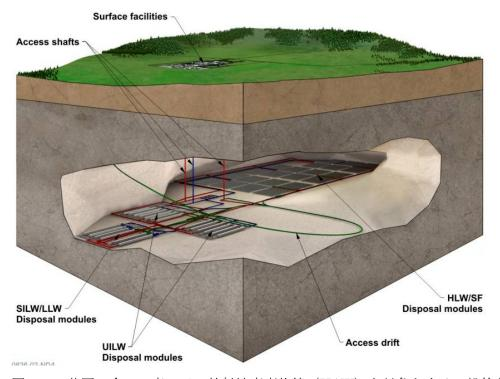
図 2-3 英国の全ての高レベル放射性廃棄物等(HAW)を対象とする一般的な条件の(すなわち特定の母岩に関するものではない)GDFの概略図(SF:使用済燃料、UILW:未遮蔽 ILW、SILW:遮蔽 ILW。)
