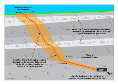
図 2-12 q、T、F 及び A が、例として挙げた地下水流動場ならびに移行する放射性核種プルームとどのように関連するかを具体的に説明する図
