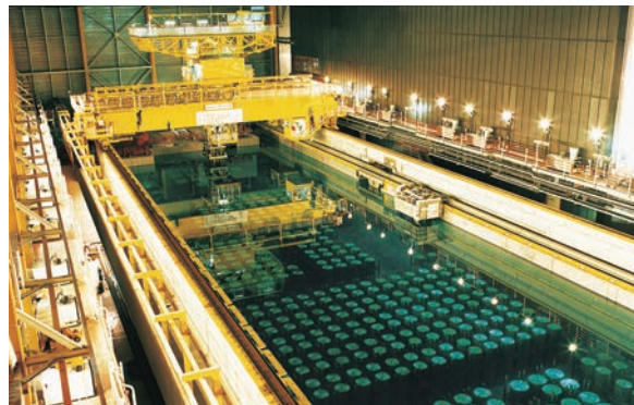
酸化燃料再処理プラント（THORP）内の 使用済燃料貯蔵プール (セラフィールド社ウェブサイトより引用)
