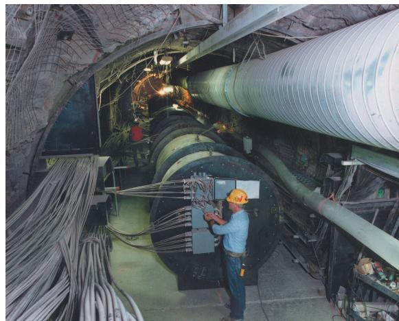
探査研究施設（ESF）でのヒーターテストの様子
