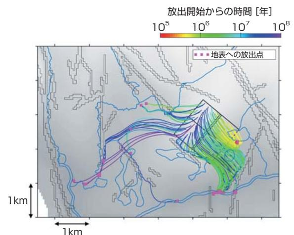
放射性物質の移行挙動のシミュレーション例
