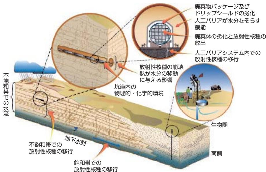
トータルシステム性能評価(TSPA)のためにモデル化されたプロセスの概略
