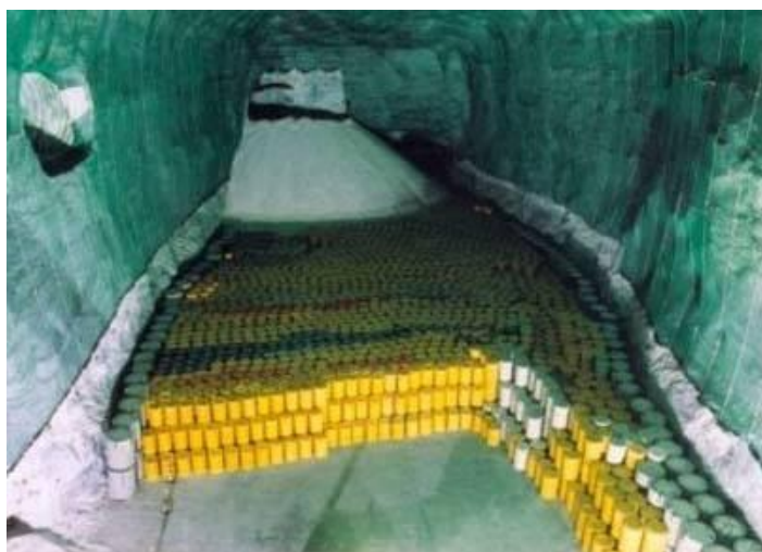
モルスレーベン処分場における 廃棄物の定置風景 (DBE社提供)
