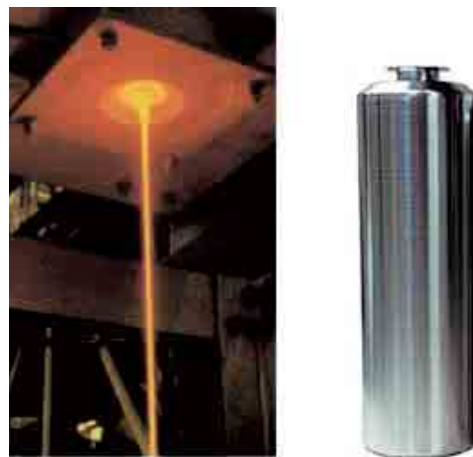
溶融したガラスの注入装置と ガラス固化体用キャニスタ（CSD-V） (ANDRAウェブサイトより引用)
