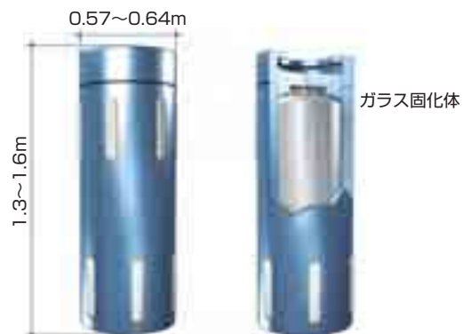
ガラス固化体用の廃棄物パッケージ (出典：Dossier 2005 TAG Figure4.2.1)
