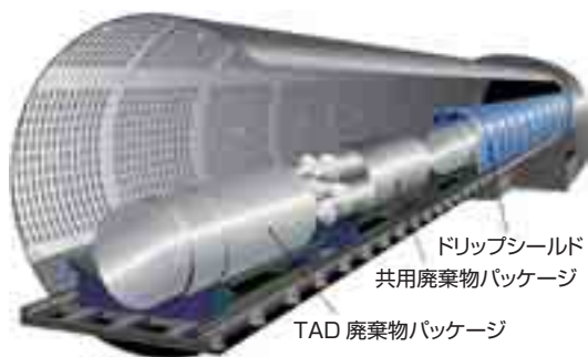
定置坑道と廃棄物パッケージの概念 (DOEウェブサイトより引用)
