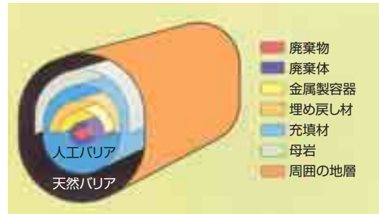
多重バリアシステムの考え方
