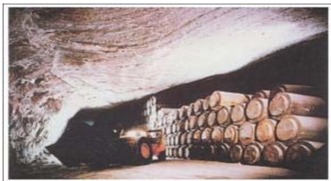
1978年頃のアッセⅡ研究鉱山での 低・中レベル放射性廃棄物の定置風景 (DBE社提供)
