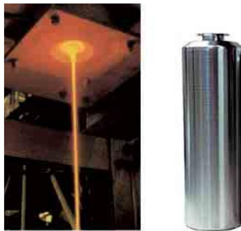
溶融したガラスの注入装置とガラス固化体用キャニスタ（CSD-V）
