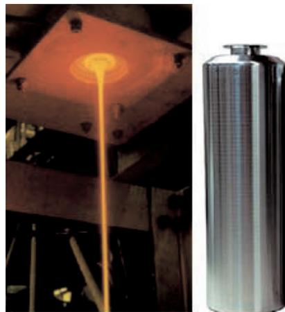
溶融したガラスの注入装置とガラス固化体用キャニスタ (CSD-V)
