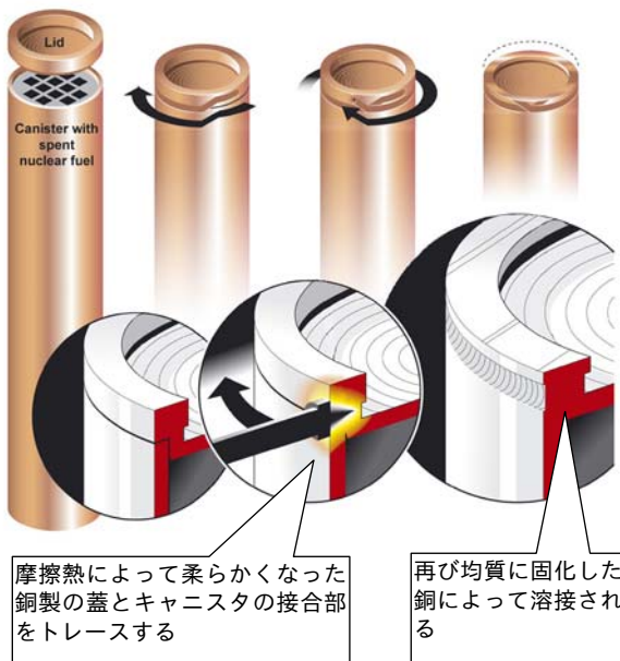
摩擦攪拌溶接の仕組み
