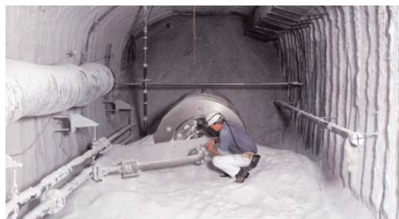
アッセII研究鉱山での実規模キャスクを用いた実験の様相 (写真提供：DBE)
