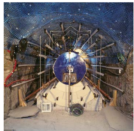
模擬キャニスタを用いた試験 (NAGRAウェブサイトより引用)
