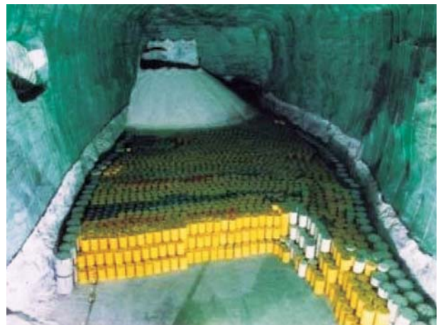
モルスレーベン処分場における廃棄物の定置風景 (DBE社提供)
