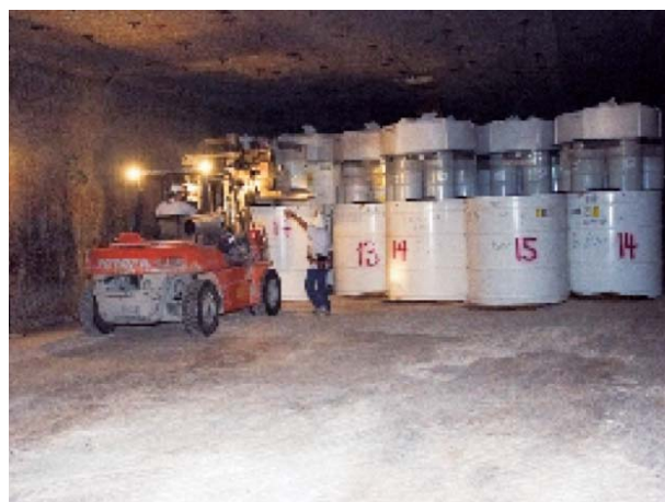
廃棄物定置状況 (DOE ウェブサイトより引用)
