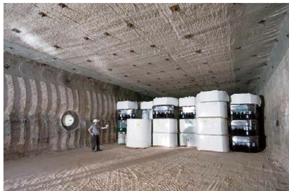
廃棄物隔離パイロットプラント（WIPP）での廃棄物定置状況 （DOE WIPPウェブサイトより引用）
