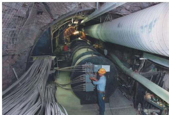
探査研究施設（ESF）でのヒーターテストの様子 (DOEウェブサイトより引用)
